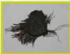
**Una selección de triturado small** (eligiendo aquellas piezas con una mayor presencia de fibras de acero de gran longitud y menor cuerpo de caucho) con el fin de añadir elementos con gran capacidad de absorción de ondas y con un refuerzo metálico que mejorará la adherencia de estas piezas.
