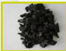
**Chip, piezas de menor tamaño** (12-25 mm) compuestas principalmente de caucho con presencia de textil. Su menor tamaño permite una mezcla de hormigón mucho más
