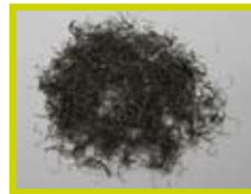
**Fibras de acero** procedentes de la separación en el proceso del granulado, con distintas características en función de la tecnología de granulación de la que proceden. Aunque el uso de fibras de acero tiene una
