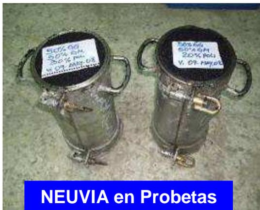
NEUVIA en Probetas 150x300mm
