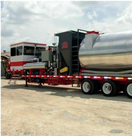
**Figura 9. Unidad de fabricación in situ de betunes caucho**
