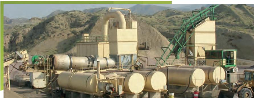
**Figura 8. Central continua de fabricación de mezclas asfálticas**
