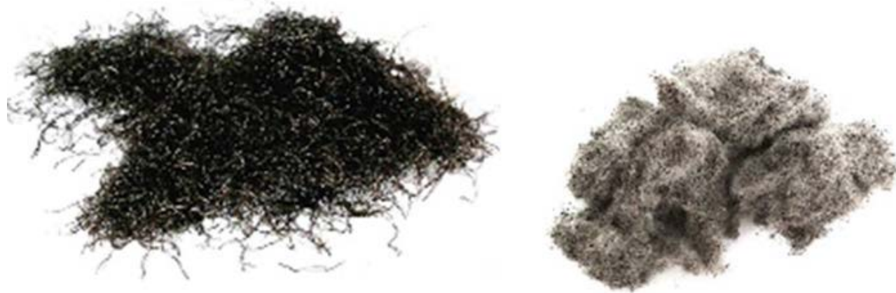
Figura 4. Acero y fibra textil separados durante el proceso de transformación.
