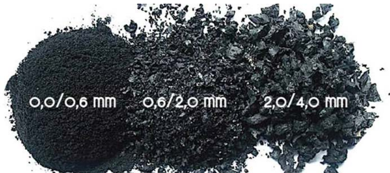
Figura 5. Diferentes granulometrías del caucho procedente de los NFVU.
