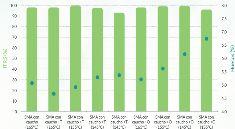
Figura A.6. Resultados de ITSR para probetas preparadas con compactador giratorio
