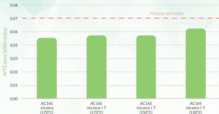
Figura B.8. Resistencia a las deformaciones permanentes (vía seca)
