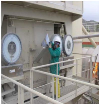
**Figura 19. Detalle de la dosificación de caucho de forma manual directo al mezclador a través de sacas**
