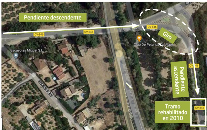
**Figura B.6. Esquema del tramo de la carretera CV-846 rehabilitado con mezcla fabricada con polvo de caucho por vía seca**
