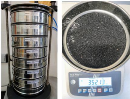
**Figura 2. Equipo de tamizado para el análisis granulométrico**
