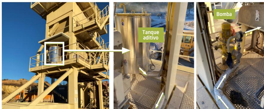
**Figura 20. Detalle del sistema de almacenamiento y dosificación de aditivos líquidos en plantas asfálticas discontinuas incorporado a la línea de ligante previo a la entrada de la báscula de pesaje**
