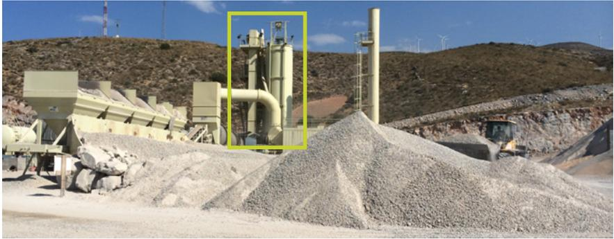
**Figura 13. Detalle del silo del filler de aportación de una planta asfáltica discontinua**
