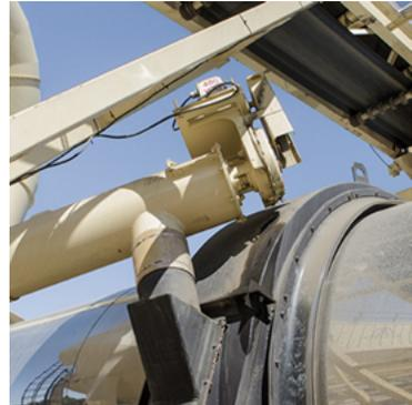
**Figura 17. Detalle de la zona de incorporación del polvo de caucho en plantas continuas**
