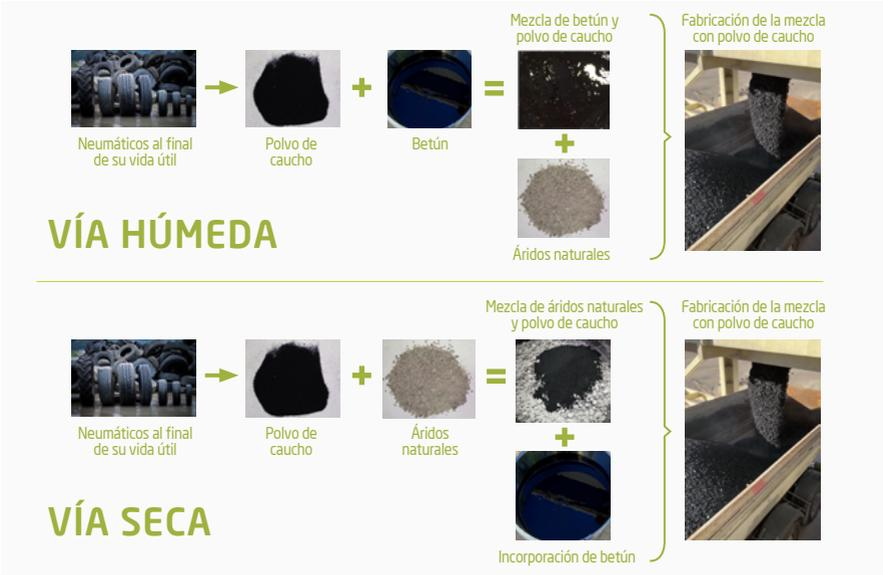
**Figura 1. Principales formas de fabricación de mezclas bituminosas con polvo de caucho procedente del neumático al final de su vida útil**
