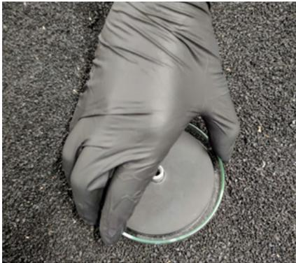
**Figura 4. Análisis del contenido de material ferromagnético**
