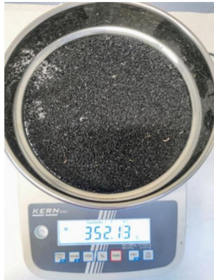
**Figura 2.2. Equipo de tamizado para el análisis granulométrico.**
