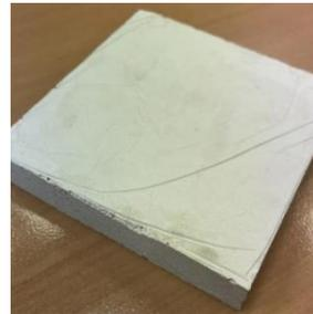
**Figura 2.13. Probeta para ensayos de reacción al fuego.**
