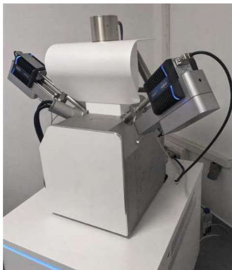
Figura 2.17. Equipo de microscopía electrónica de barrido empleado.
