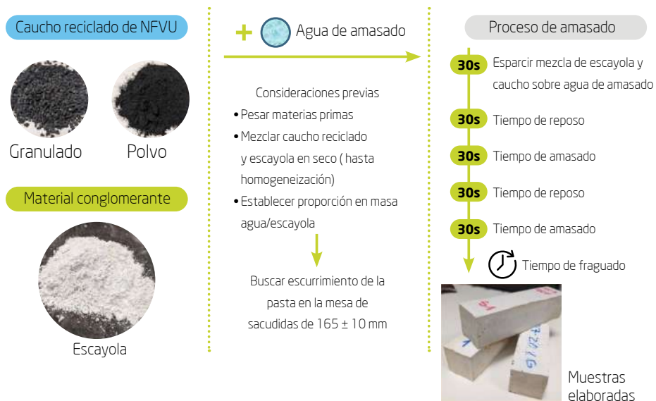
Figura 2.8. Proceso de preparación de los compuestos de escayola.
