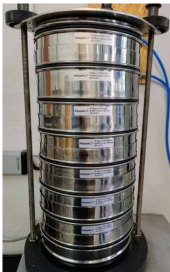
Figura 2.2. Equipo de tamizado para el análisis granulométrico.
