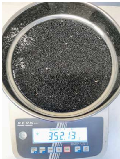
Figura 2.2. Equipo de tamizado para el análisis granulométrico.
