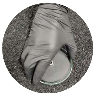
Figura 2.4. Análisis del contenido de material ferromagnético.
