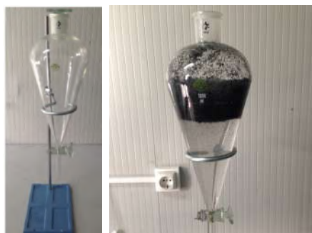
Figura 2.5. Material de laboratorio para el análisis del contenido de otras impurezas.
