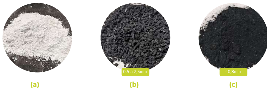
Figura 2.1. Materias primas empleadas: (a) escayola, (b) fracción de caucho granulado, (c) fracción de caucho en polvo.
