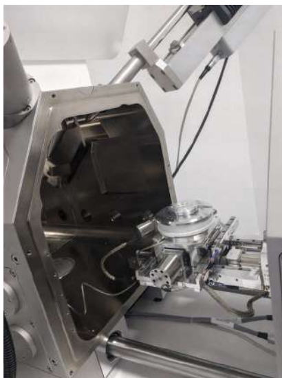
Figura 2.17. Equipo de microscopía electrónica de barrido empleado.
