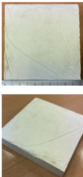
Figura 2.13. Probeta para ensayos de reacción al fuego.
