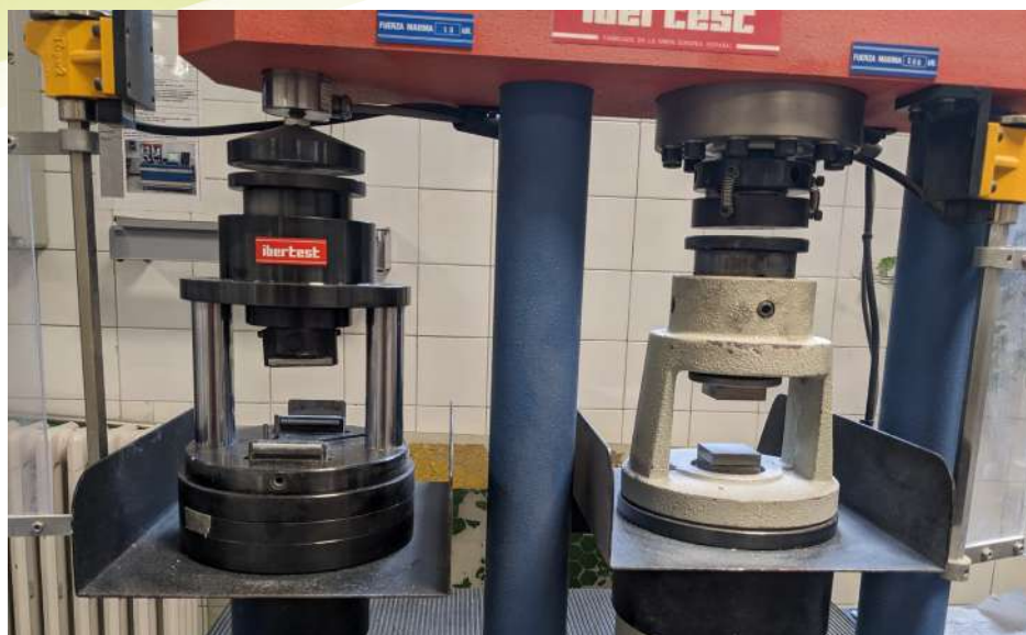
Figura 2.16. Prensa de ensayos mecánicos para determinar la resistencia a flexión y a compresión.
