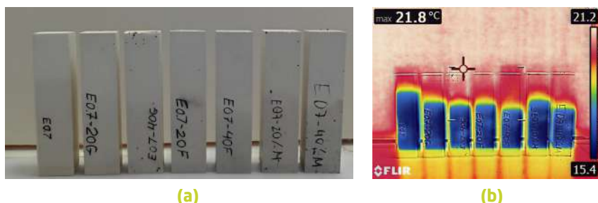
Figura 3.9. Altura alcanzada por el agua tras el ensayo de capilaridad: (a) fotografía de las probetas y (b) termografía. Probetas ordenadas E0.7; E0.7-20%G; E0.7-40%G; E0.7-20%P; E0.7-40%P; E0.7-20%M; E0.7-40%M.
